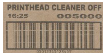
Obstructions et altération du code bien visibles
